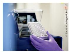
Mit dem Massenspektrometer identifizierten die Wissenschaftler über 200 verschiedene Lipide aus dem Blutplasma anhand deren Masse und Ladung.
