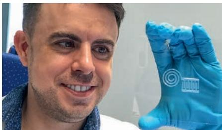
Empa-Forscher Gilberto Siqueira demonstriert den frisch ausgedruckten Nanocellulose-Schaltkreis. Nach einem Trocknungsprozess lässt sich das Material weiterverarbeiten (© Empa).
