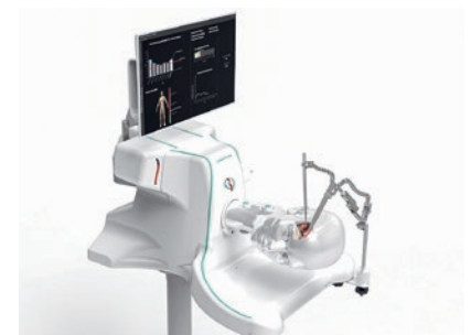
Am 4D-Simulator mit patientenspezifischem Kopfmodell können komplexe Hirnaneurysma-OPs trainiert werden (© SurgeonsLab).
