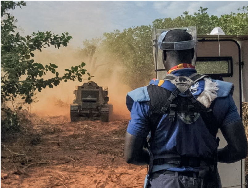
Sicherheit über alles: Das Fahrzeug wird von einer Person aus sicherer Distanz zum Gefahrenbereich ferngesteuert.
