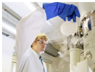
Lukas Gerken refroidit un microscope électronique avec de l'azote liquide.
