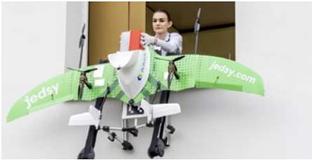
Die Drohne dockt am Fenster des Labors an.
