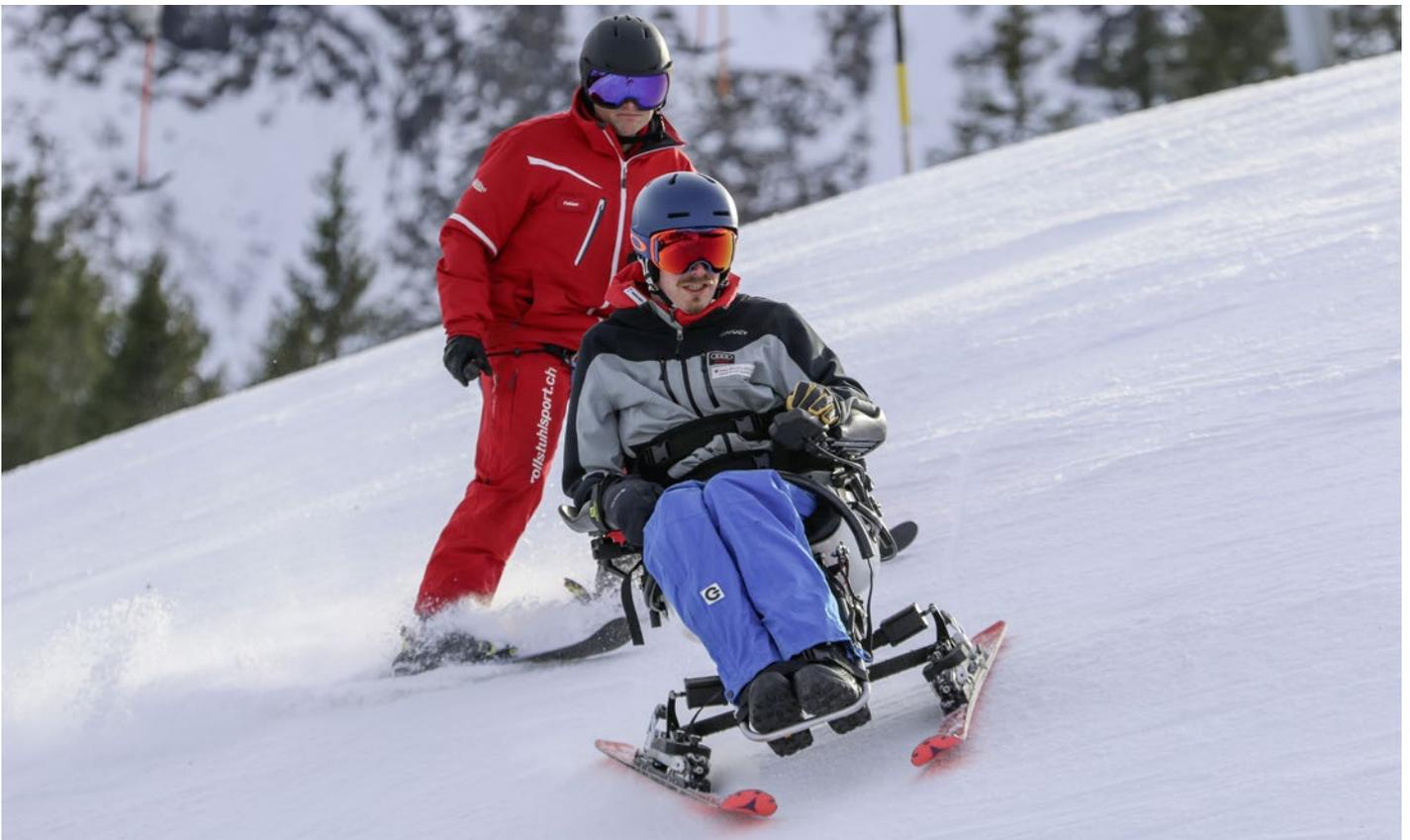
**Skifahren für alle** Ein Skibob für gelähmte Personen: Das an der University of Utah entwickelte Gerät «TetraSki» kommt erstmals nach Europa und wurde in Sörenberg testgefahren. Die Steuerung erfolgt per Hand über einen Joystick oder per Mund, um die Kurvenlage und die Geschwindigkeit zu kontrollieren. Ab der Wintersaison 2023/24 wird der TetraSki über die Website der Schweizer Paraplegiker-Vereinigung buchbar sein.
